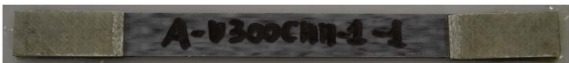
Figura 3 – Applicazione dei tabs in G-FRP alle estremità del campione
